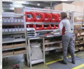
De werkpost van de voormontage werd volledig herwerkt in systeemprofielen (Foto: Sabrina Gevers)
