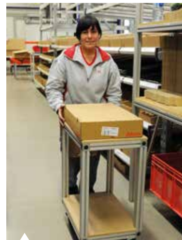
Karin laat zien dat de onderdelenpicking nu gebeurt met karretjes. Gevulde onderdelendozen worden zonder heffen van het rolkarretje op de controletafel geduwd. Bjorn Smet (Technische Dienst) maakte deze karretjes op maat volgens de gestalte van wie ze gebruikt.
