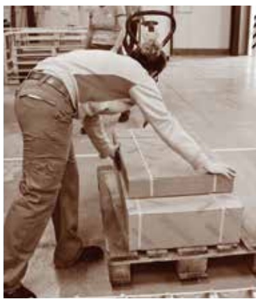
Veel lof is er ook voor de nieuwe ergonomische transpallet aan de lade-afwerking op lijn 1. De transpallet werkt met een laserstraal die ervoor zorgt dat de pallet automatisch zakt wanneer er een doos wordt opgeschoven. Hierdoor hoeft Shirley zich niet meer te bukken, een groot verschil!
