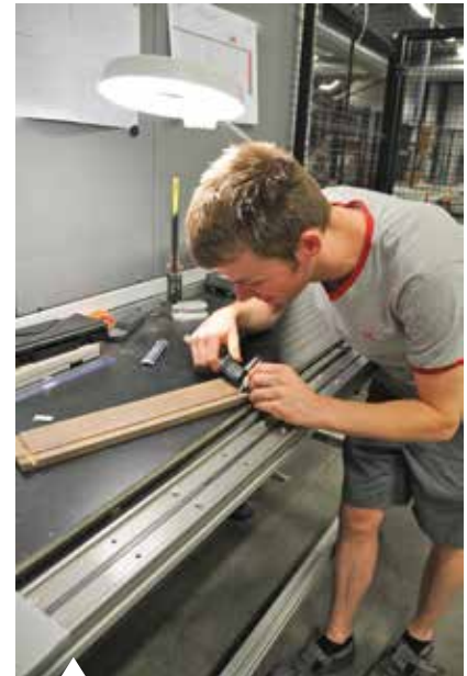
Op de meetbank controleert Brecht of zijkanten, groeven, bodems en ruggen de exacte afmetingen hebben die hij op de zaag had ingesteld.
