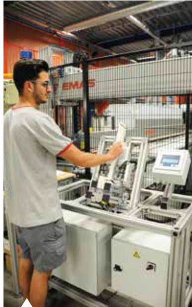
Yoni test het ontgrendelmechanisme van de fronthaak. Dit mechanisme zit in de ladezijkanten van TA'OR BOX en met deze testmachine kan je nagaan of het correct functioneert.
