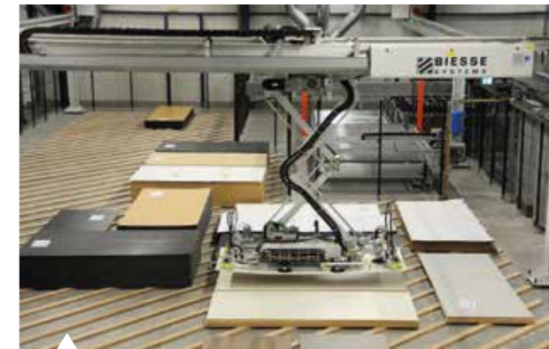
Het volautomatische platenmagazijn zorgt voor de aanvoer van plaatmateriaal naar de zaagmachine
