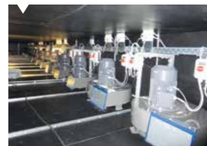
De filters en motoren aan de binnenkant van de stofafzuiging
