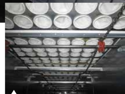
De filters en motoren aan de binnenkant van de stofafzuiging
