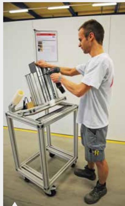
Kevin Maes demonstreert hoe de spoelbaklade wordt gemonteerd
