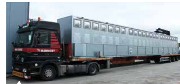
De 17 m lange filterkast werd met een speciaal transport in één stuk geleverd
