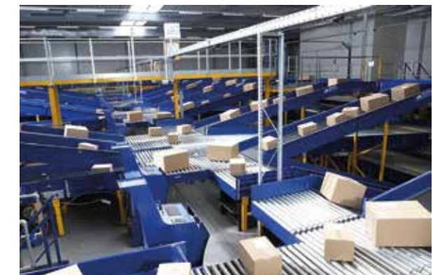
4 Automatisch aangestuurde transportbanden in een depot van GLS verdelen de pakketten
